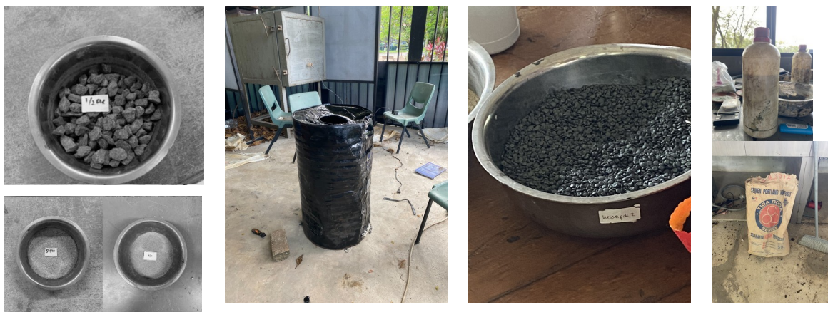
Gambar 16. Material komponen campuran aspal (a) agregat, (b) bitumen 60/70 Shell, (c) polimer EVA, dan (d) aditif WMA Rediset dan filler semen Portland
