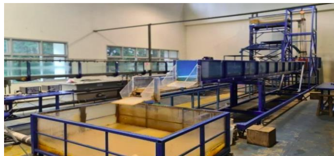
Gambar 4. Flume Saluran Terbuka
