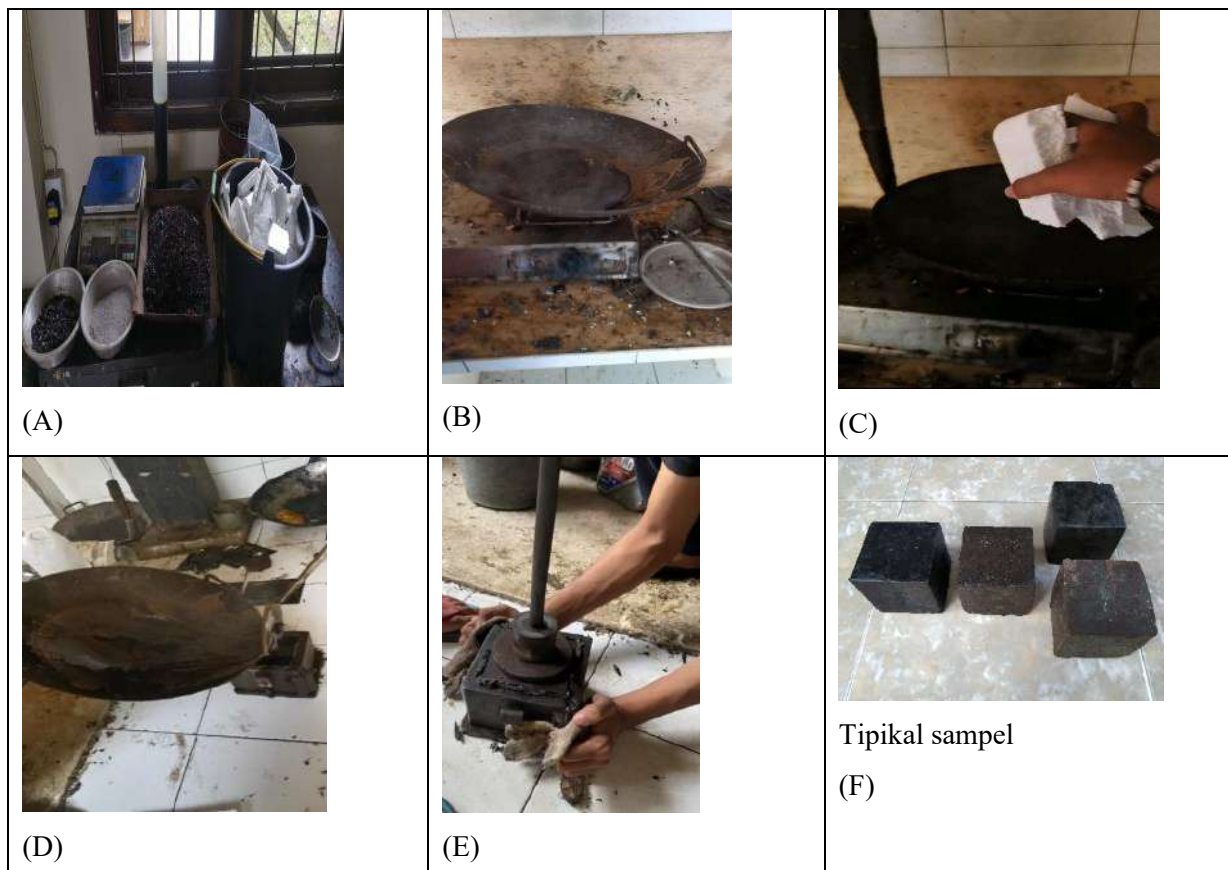
Gambar 1. Pembuatan Benda Uji BPBPD
