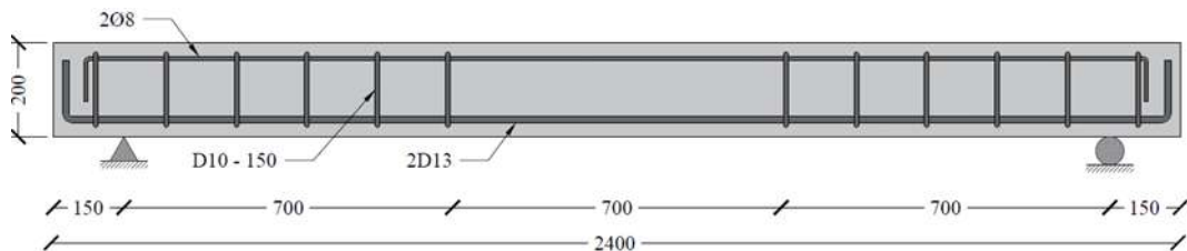
Gambar 1. Potongan Memanjang Benda Uji BJTU.D13
