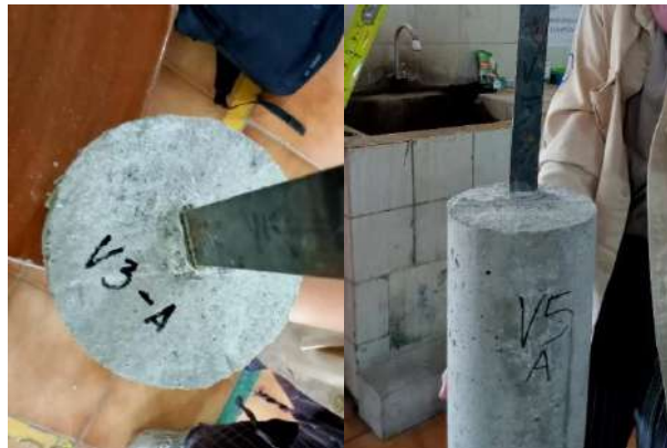
Gambar 16. Benda Uji yang Mengalami Pull Out Failure
