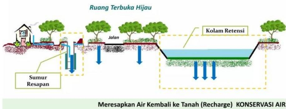
Gambar 2. Sistem Bangunan Resapan dan Kolam Penampungan
