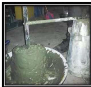
Gambar 8 Pengujian Slump dengan Mix design SNI 03-2834-2000
