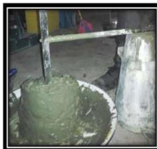
Gambar 8 Pengujian Slump dengan Mix design SNI 03-2834-2000
