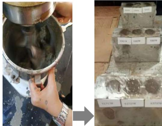
Gambar 2. Proses pencampuran geopolimer perekat geopolimer
