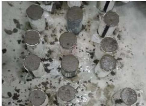
Gambar 2. Dokumentasi Pembuatan Benda Uji
