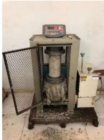
Gambar 5. Proses Pengujian Kuat Tekan
