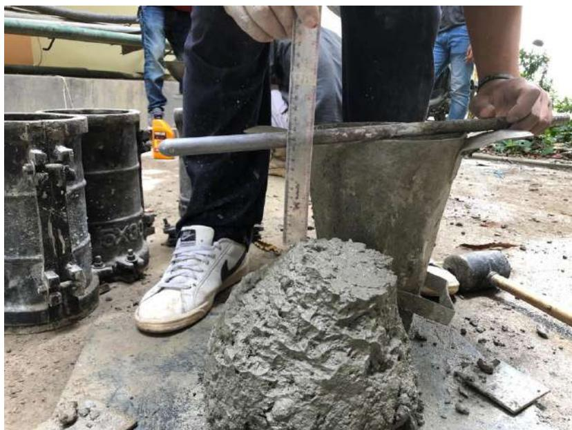
Gambar 4. Uji *Slump*
