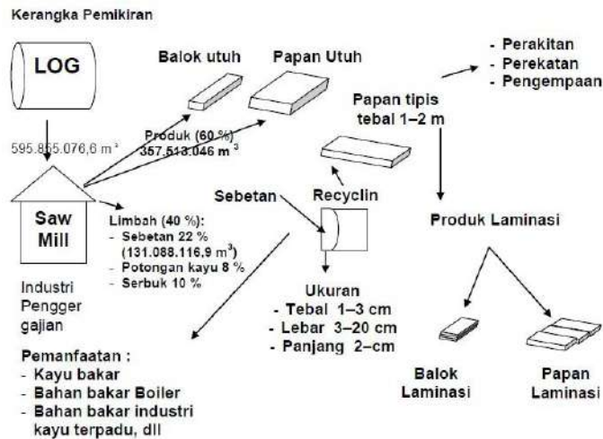
Gambar 3. Balok dari limbah kayu (Purwanto, 2011)
