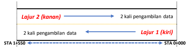
Gambar 7. Pengukuran IRI pada Lajur Jalan
