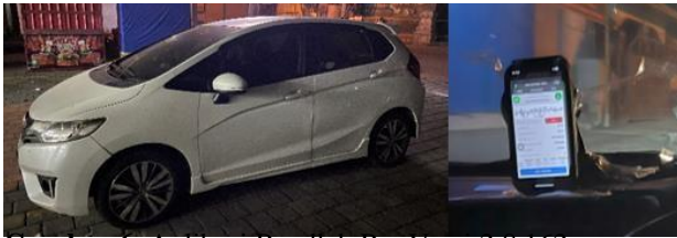
Gambar 6. Aplikasi Roadlab Pro Versi 2.0.162 yang Dipasang pada Mobil Honda Jazz
