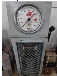
Gambar 2.3 Pengujian Kuat Tekan Mortar
