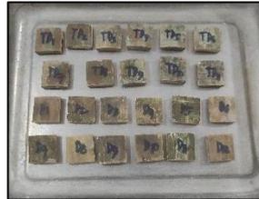
**Gambar 3.** Spesimen pada pengujian kadar air dan kerapatan pada bambu Petung
