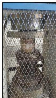
**Gambar 4.** Pengujian Kuat Geser Bambu
