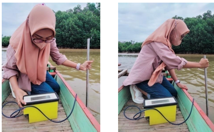
Gambar 6. Pengambilan data kecepatan aliran menggunakan current meter
