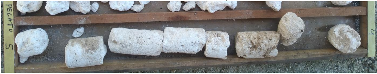
Gambar 7. Core box hasil pengeboran di daerah Pantai Bingin kedalaman 4-5 meter
